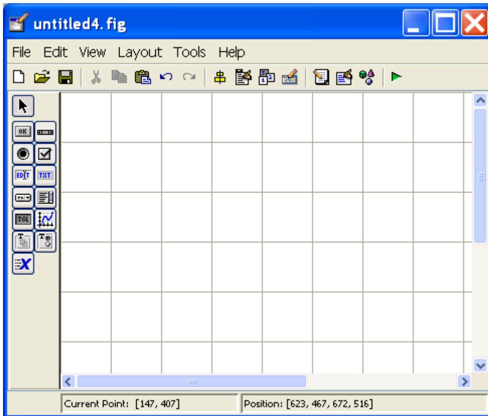
Folgende Komponenten sind im Dialog-Editor zu erkennen. Die Toolbar am linken Fensterrand beinhaltet alle Steuerelemente, die für eine GUI verwendet werden können.
